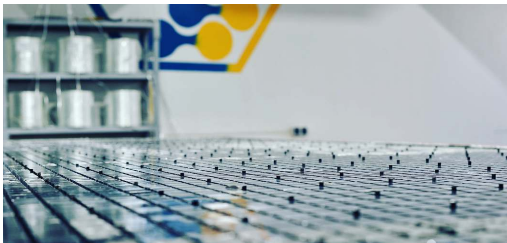
3. Оборудование для производства композитных решетчатых настилов
